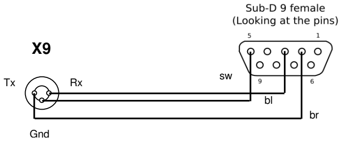
Bild 4 – Pinbelegung X9 int. RS232-Schnittstelle
