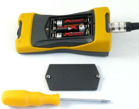
Im Auslieferungszustand sind die Batterien eingelegt. Zum Wechseln der Batterien wird das Batteriefach mit einem Kreuzschlitzschraubendreher geöffnet und die Batterien werden ausgetauscht. Entfernen Sie die Batterien, wenn Sie das Gerät für lange Zeit nicht benutzen, oder es nur über USB speisen wollen. Ladegerät, Akkus und USB Netzteil sind beim Hersteller bzw. Händler erhältlich.
