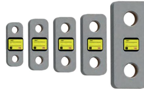
Der Zugsensor KAK-F ist ein kompaktes Messgerät zur Bestimmung von Lasten an Kranhaken und Seilspannungen. Zuglaschen, Haken und die Fernbedienung machen das Messgerät Funkkranwaage. Die Funkfernbedienung arbeitet mit einer Frequenz von 868 MHz und ermöglicht die komplette Fernsteuerung der Kranwaage. Die Messdaten können damit auch zu einem PC übertragen werden. Der Zugsensor arbeitet unabhängig von der Fernsteuerung und mit Standardbatterien (4x AA) bis zu 140 Stunden.
